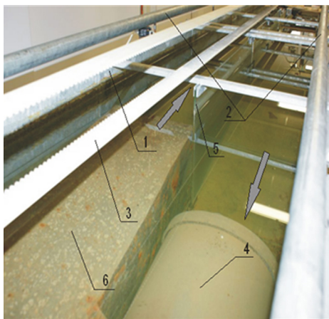
Ryc. 6. Kanał doświadczalny z turbiną
