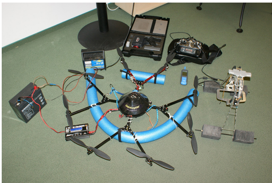
Ryc. 15. BSP – oktokoptyer używany do badań terenowych Źródło: opracowanie własne.
