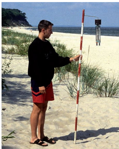
Ryc. 5. Pomiar temperatury i wskaźników wilgotności powietrza psychrometrem aspiracyjnym Assmanna
