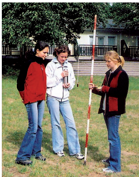
Ryc. 6. Pomiar wielkości ochładzającej powietrza katatermometrem Hilla
